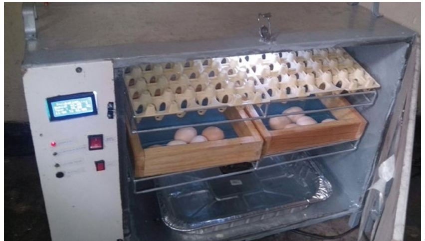
L'Egg Incubator utilise une technologie qui simule le processus naturel par lequel une poule couve ses œufs dans un environnement artificiel.
