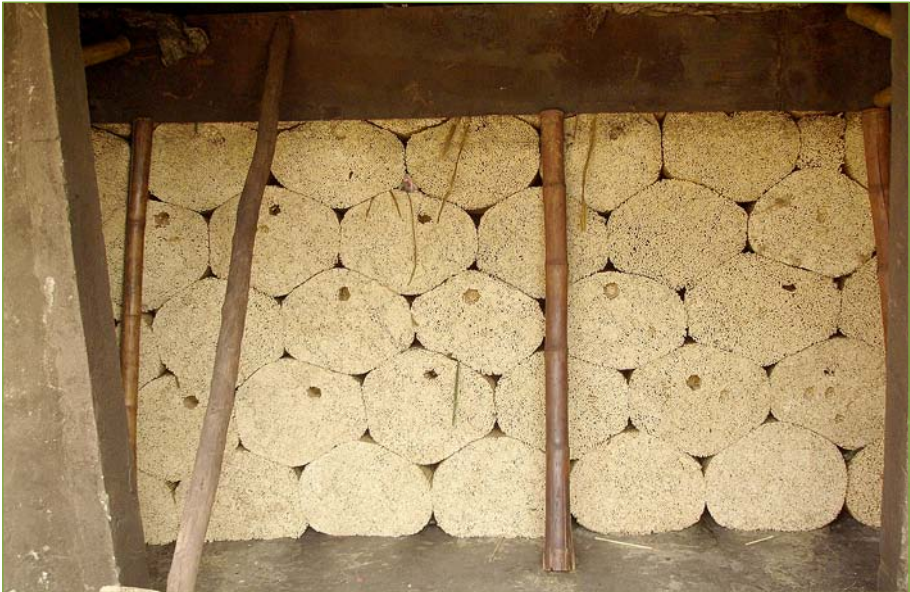
Séchage des baguettes brutes dans un four. Patrice Lamballe, Gret.
