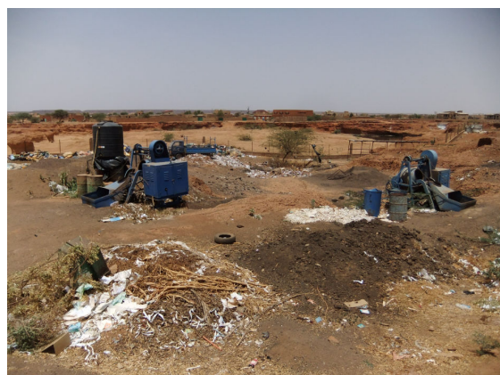
Site de compostage de ASE-Niger (Commune I de Niamey); Les bétonnières servent à faire le mélange (fiente, débris végétaux, terreau, eau)
