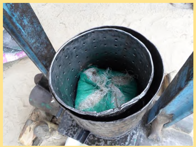
5 ème étape : Après la cuisson, on met l'arachide dans de petits sachets avant de la presser pour en extraire l'huile
