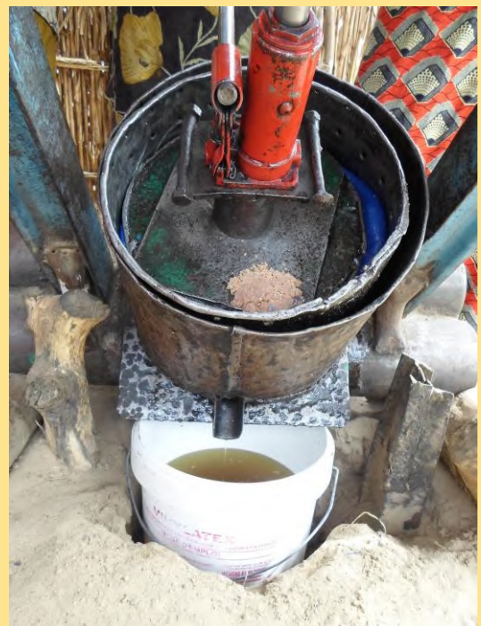
5 ème étape : Après la cuisson, on met l'arachide dans de petits sachets avant de la presser pour en extraire l'huile
