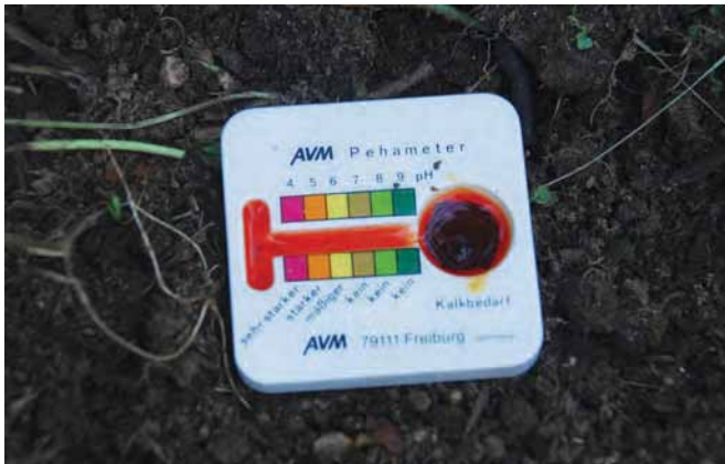
Photo 7.1 Un pH-mètre® est un outil à bas prix utile pour mesurer le pH du sol au champ.
