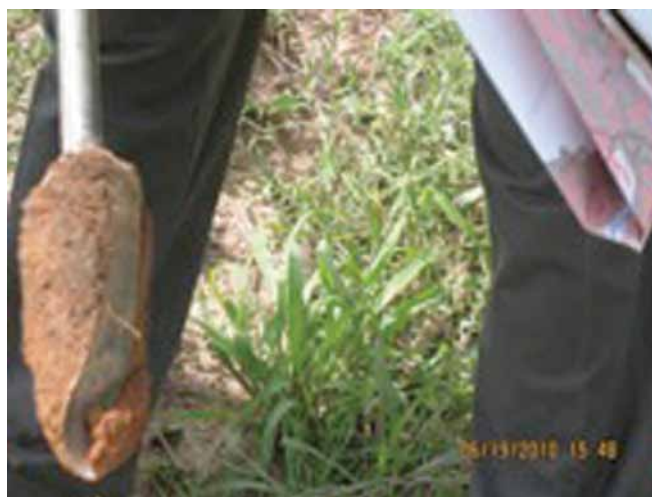
Photo 6.4 La tarière Edelman est conçue pour prélever des quantités égales de sol de chaque profondeur échantillonnée.
