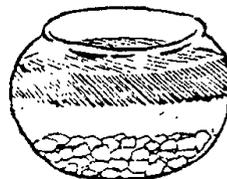
6- Placer le pot servant de filtre sur le deuxième pot et verser l'eau. L'eau devra être versée lentement pour ne pas déranger et mélanger les couches de charbon de bois et de sable.
