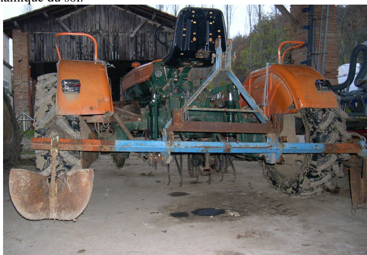
Photo : Tracteur équipé d'une butteuse pour confectionner les planches et de système ventrale de binage
