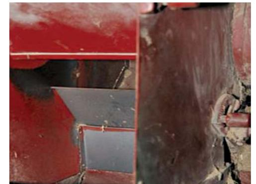
L'espace entre les lames de séparation doit être réglé de manière à permettre une bonne séparation entre le riz décortiqué et le paddy, en regardant de façon continue le résultat obtenu.
