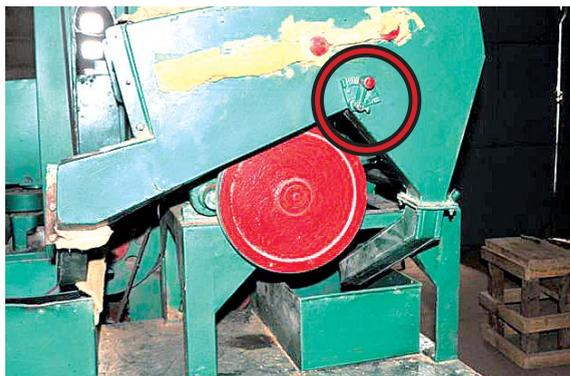
La sortie du riz blanchi doit être réglée, en regardant de façon continue le résultat obtenu.
