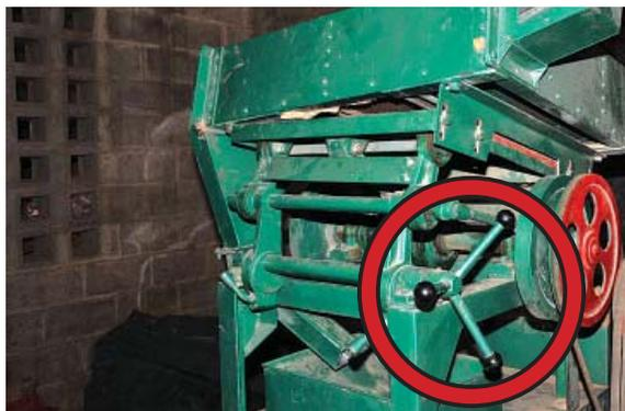
Le flux du riz cargo dans le blanchisseur doit être réglé.
